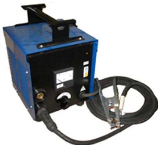
Аппараты разморозки труб предназначены для ликвидации ледяных пробок в металлических трубопроводах тепло и водоснабжения, а также в магистралях сжатого воздуха без демонтажа труб и без вскрытия теплоизоляции путем пропускания по трубе электрического тока при безопасном напряжении.
